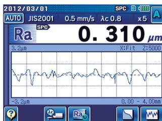
波形顯示：顯示運算結果及評估曲線
