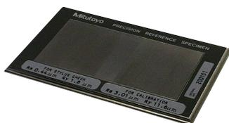
顯示：Ra = 約 $3\ \mu\text{m}$ 、約 $0.4\ \mu\text{m}$
