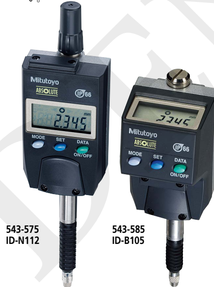
保護等級IP66の防水性を実現し、耐油性も向上
