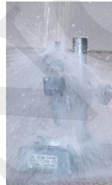
保護等級IP66の防水性を実現し、耐油性も向上
