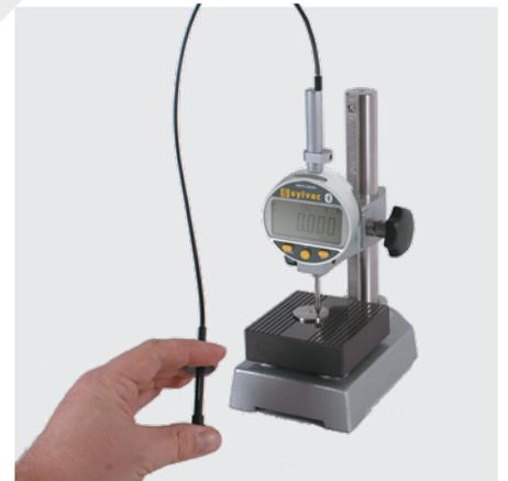
Dispositivo con foto-cable tipo 905-2216
