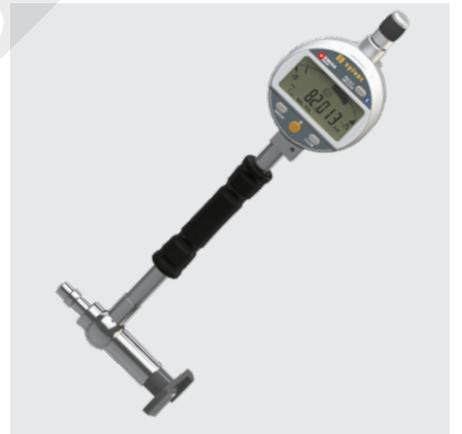
S\_Dial WORK Analog utilizado en el medidor de orificio sistema
